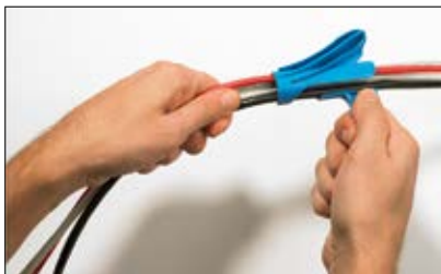
Læg et eller flere kabler i HAT montageværktøjet.
