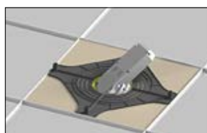
3. Indsæt downlighten gennem det skårede hul.
