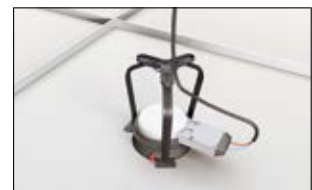
4. Tilslut strømforsyningen og fælg ledningen gennem øjet.
