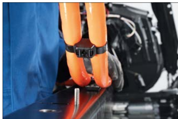
DCT produkter er til parallel føring af ledningsnet med studsmontering.
