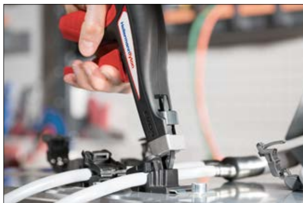
Spændetappen kan anvendes til en specifik trækstyrke.
