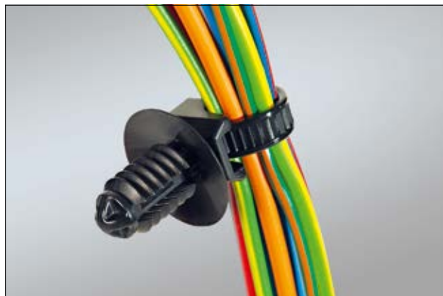
T50SOSFT6LGE for pladetykkelse fra 0,7 til 7,0 mm.
